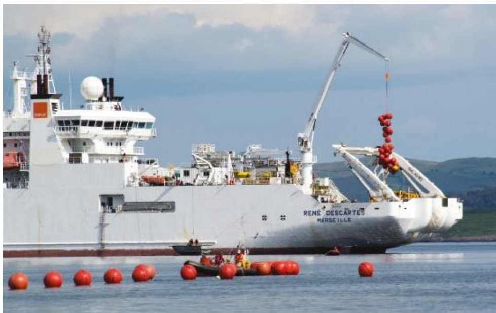
Le câblier René Descartes au moment de la pose du câble
